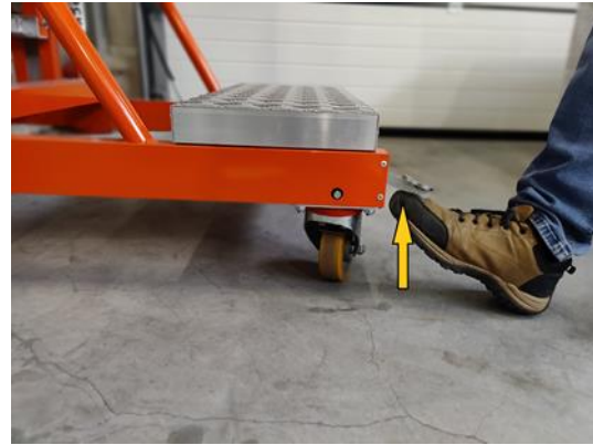
Figure 6. Déblocage des roues
