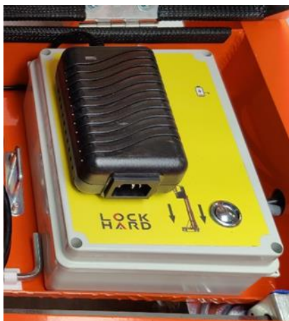
Figure 18. Système électrique de descente
