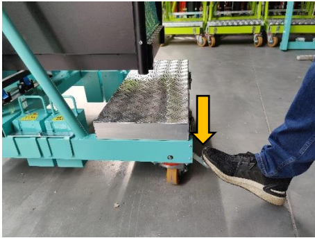
Figure 5. Blocage des roues Une pression effectuée sur la pédale provoque un blocage.
