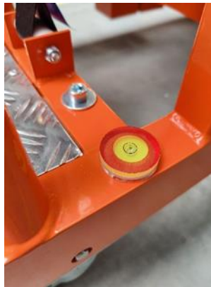
Figure 8. Niveau à bulle
