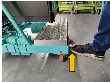
Foto 6. Desbloqueo de las ruedas Levante el pedal para desbloquear
