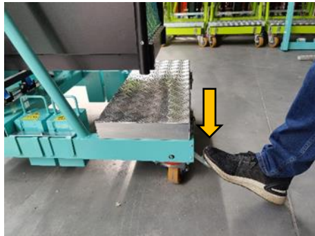
Foto 5. Bloqueo de las ruedas Presione el pedal para bloquear
