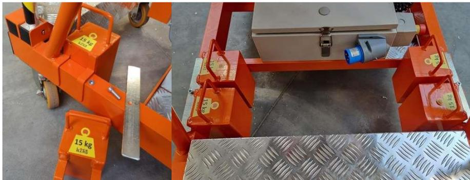
Foto 4. Montaggio delle zavorre
