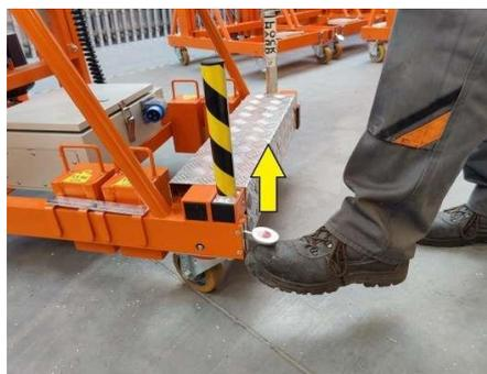
Foto 6. Sblocco delle ruote
