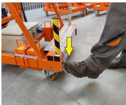
Foto 5. Bloccaggio delle ruote
