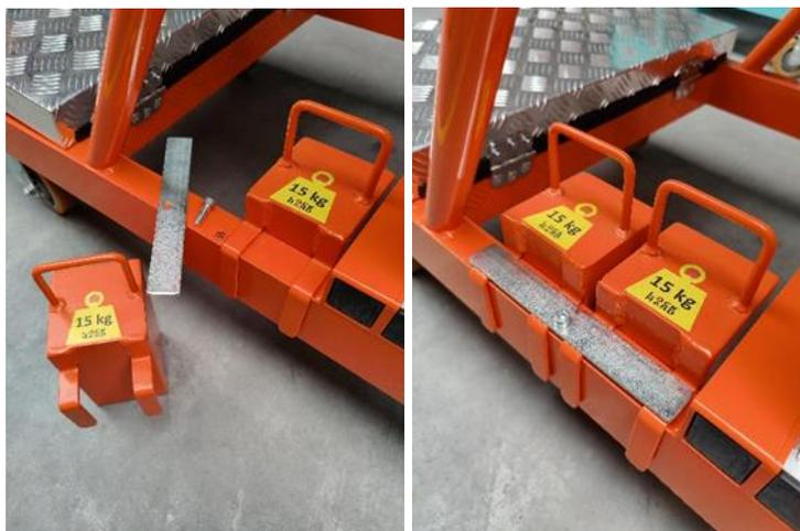
Foto 3. Montaggio delle zavorre
