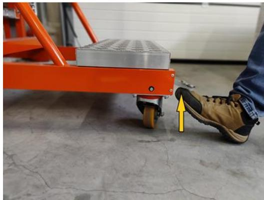
Foto 6. Sblocco delle ruote
