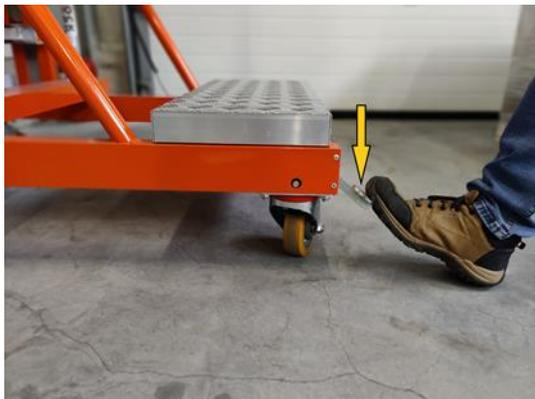
Foto 4. Bloccaggio delle ruote
