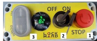
Foto 1. Pannello di controllo
