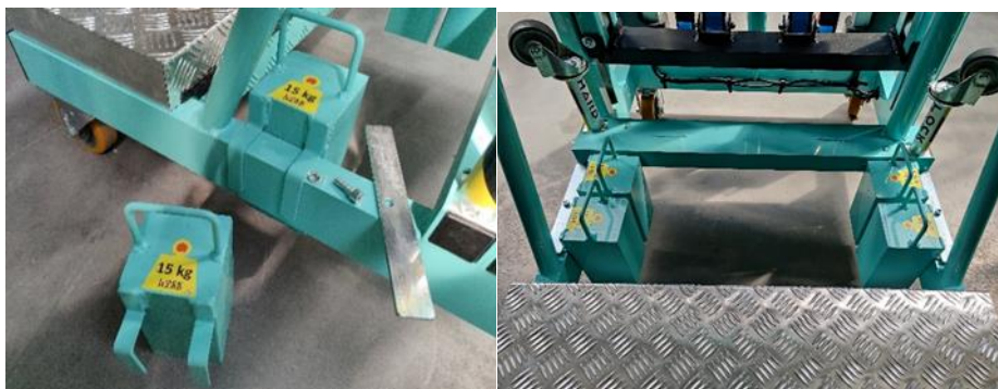
Foto 4. Montaggio delle zavorre
