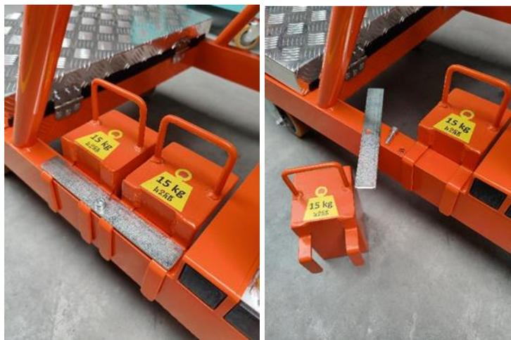
Foto 3. Montaggio delle zavorre
