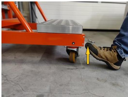
Foto 6. Sblocco delle ruote
