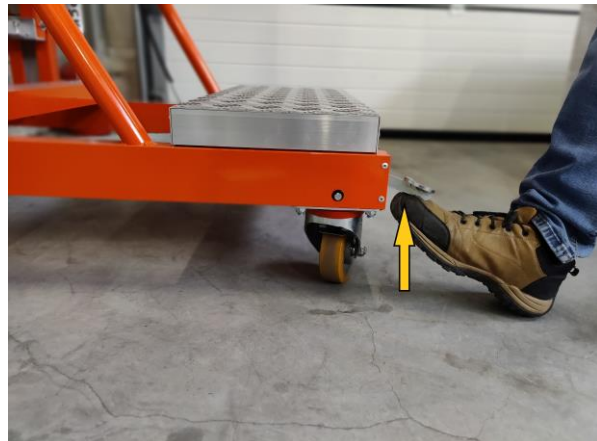
Foto. 16. Desbloqueio das rodas
