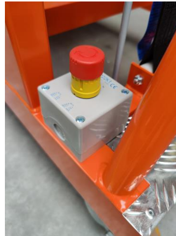
Foto 3. Botão de emergência
