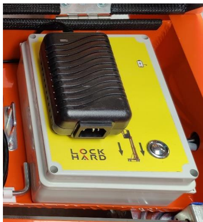
Foto. 17. Sistema elétrico de abaixamento
