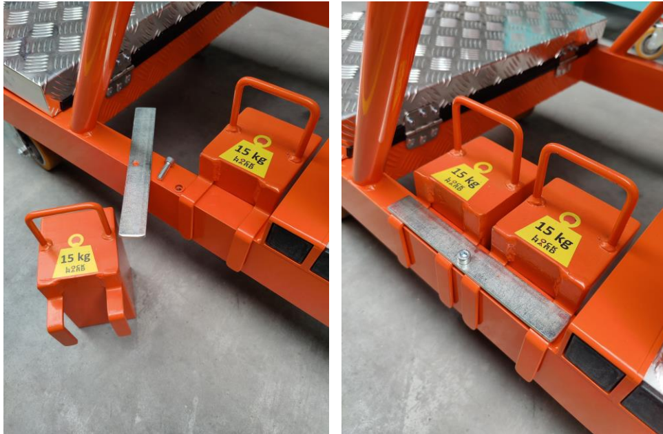
Foto 4. Instalação dos lastros
