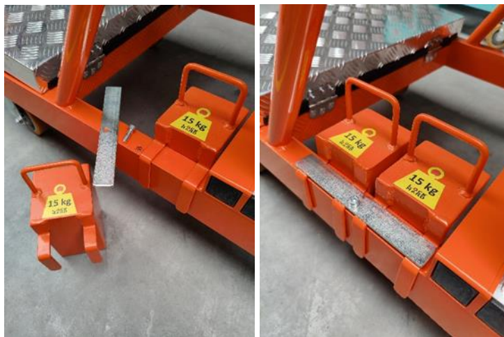
Foto 3. Montaje de los lastres
