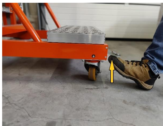
Foto 6. Desbloqueo de las ruedas Levante el pedal para desbloquear
