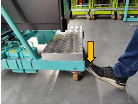
Kuva 5. Pyörän lukitus Polkimen painaminen aiheuttaa lukituksen
