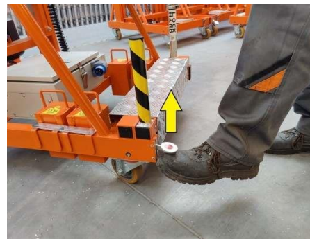
Kuva 6. Pyörien lukituksen avaaminen Polkimen nostaminen avaa pyörien lukituksen
