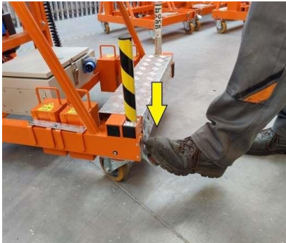
Kuva 5. Pyörän lukitus Polkimen painaminen aiheuttaa lukituksen
