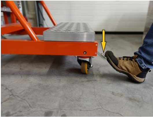
Kuva 4. Pyörän lukitus Polkimen painaminen aiheuttaa lukituksen
