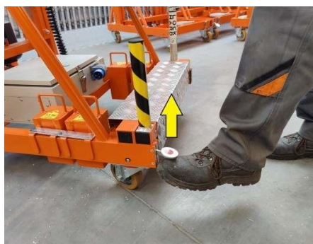
Zdj. 6 Odblokowanie kół Podniesienie pedału odblokowuje koła
