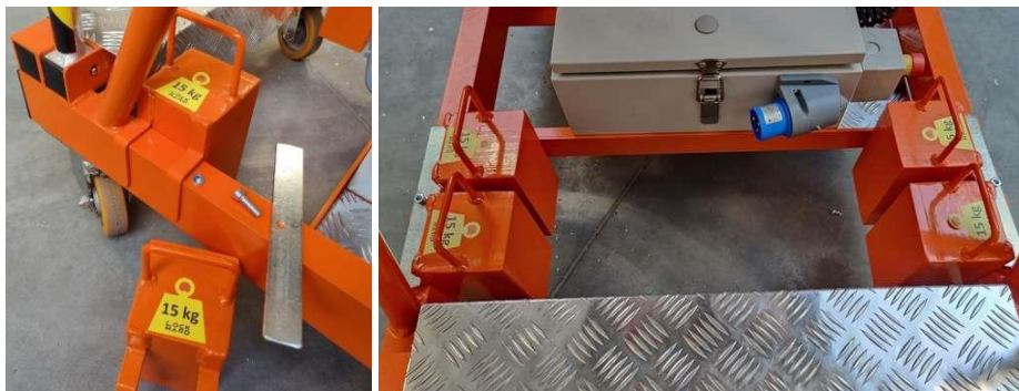
Zdj. 4 Montaż balastów
