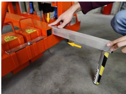
Zdjęcie 12. Wsuwanie obróconego stabilizatora
