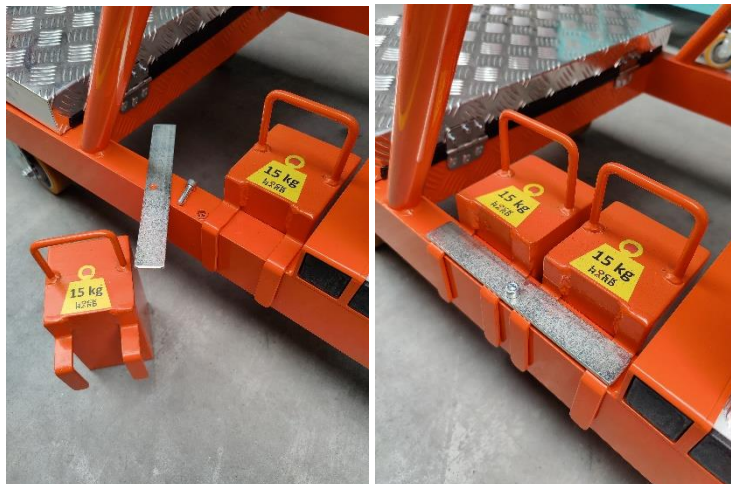
Zdjęcie 3. Montaż balastów
