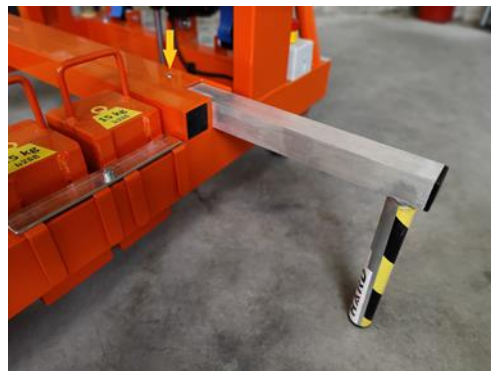
Zdjęcie 13. Zablokowany bolec zabezpieczający
