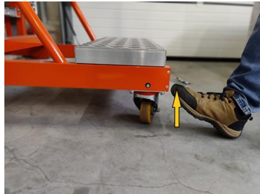
Zdjęcie 6. Odblokowanie kół - podniesienie pedału odblokowuje koła
