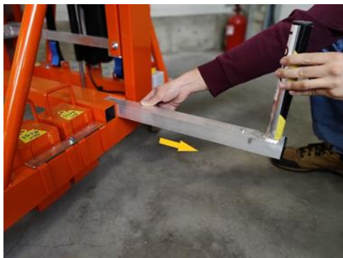
Zdjęcie 10. Wsuwanie stabilizatora z gniazda
