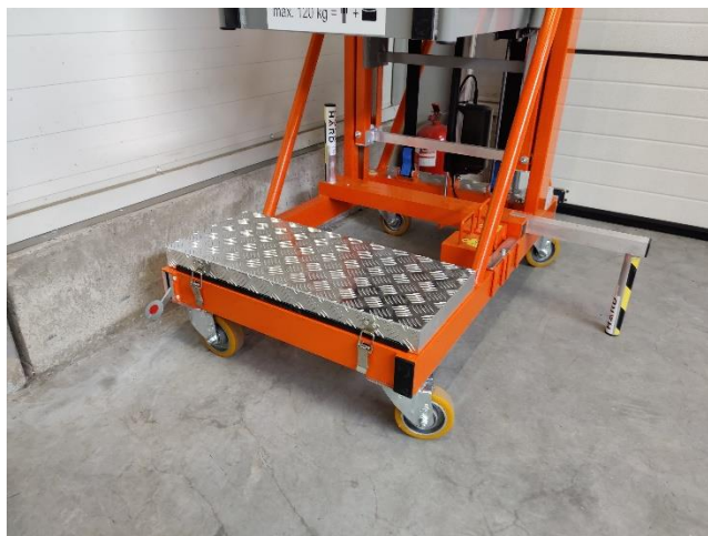
Zdjęcie 15. Jednostronne wysunięcie stabilizatorów
