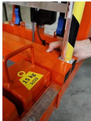
Zdjęcie 9. Wciśnięty bolec zabezpieczający
