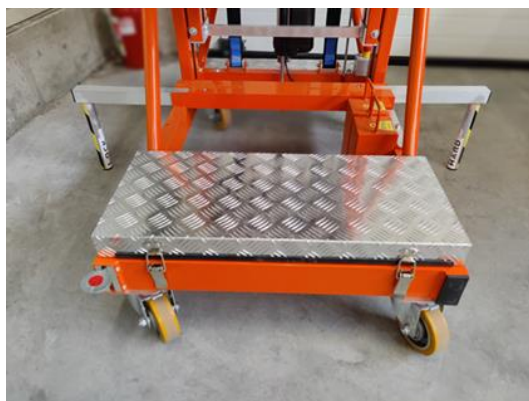
Zdjęcie 14. Rozłożone stabilizatory
