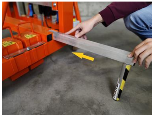
Zdjęcie 11. Wsuwanie obróconego stabilizatora
