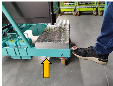
Zdjęcie 6. Odblokowanie kół Podniesienie pedału odblokowuje koła
