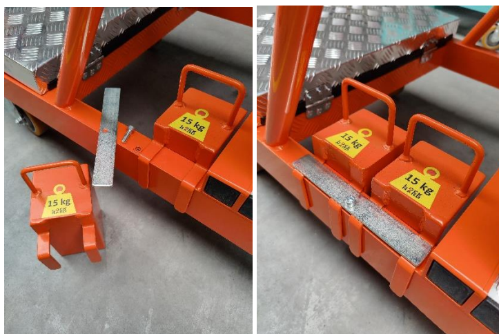
Zdjęcie 3. Montaż balastów
