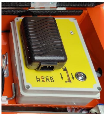
Zdjęcie 19. Elektryczny system opuszczania
