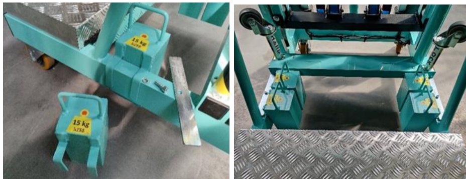
Foto 4. Montage der Ballastgewichte
