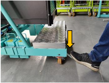
Foto 5. Radsperrung Druck auf das Pedal betätigt die Sperre
