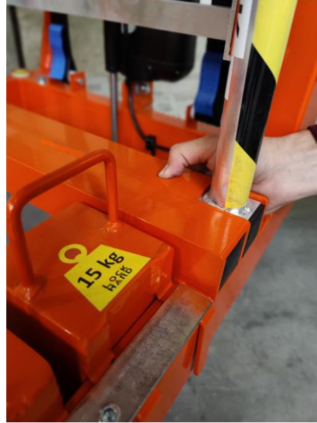
Fot 4. Beveilingspin ingedrukt
