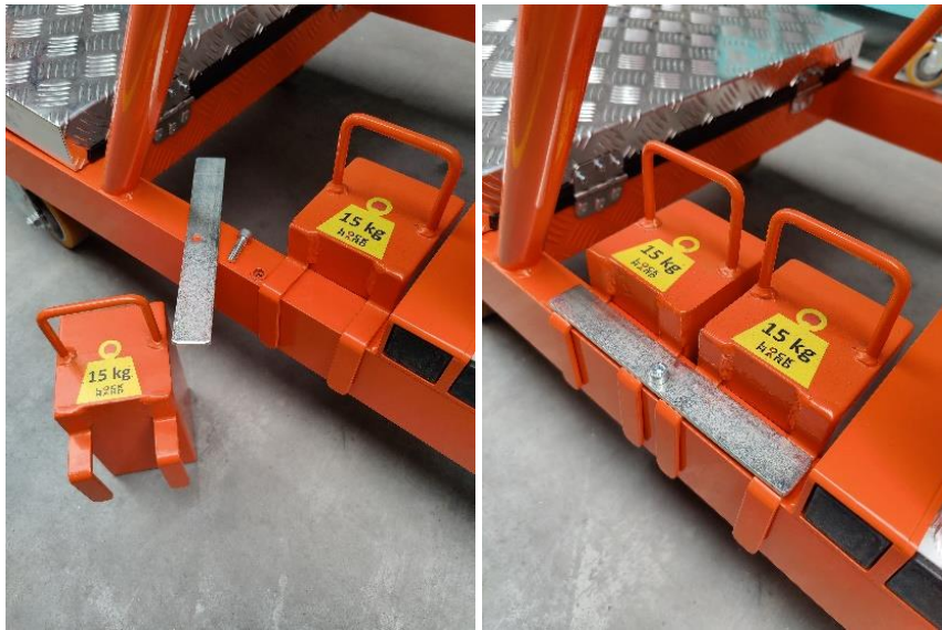
Fot 2. Montage van ballast
