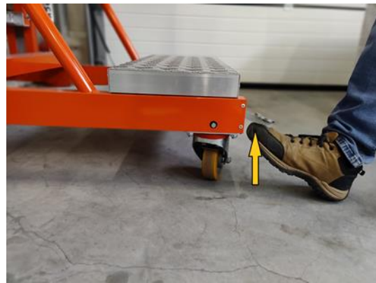
Foto 6. Wielen ontgrendelen – duw pedaal omhoog om de wielen te ontgrendelen
