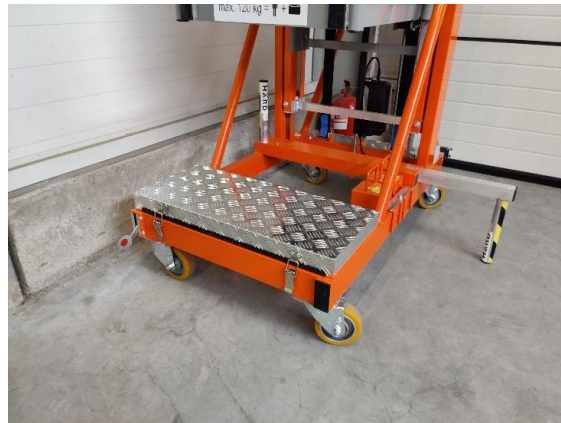
Foto 15. Eénzijdig uitgeschoven stabilisatoren
