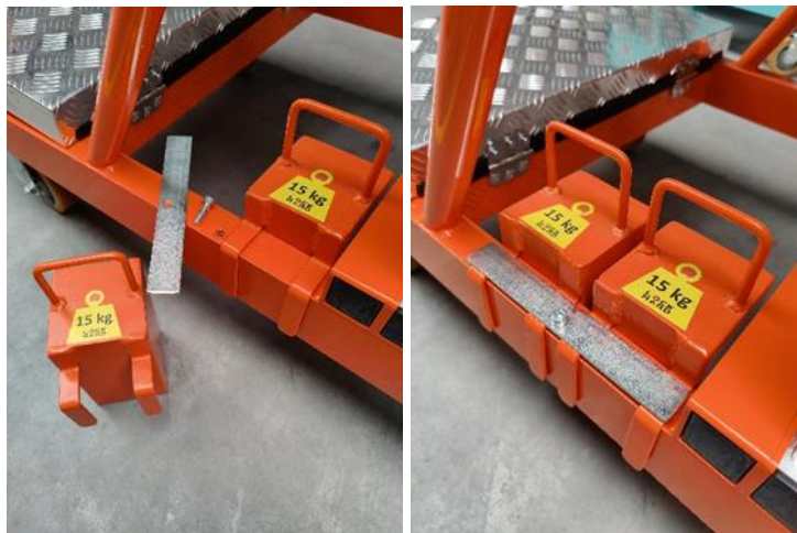
Bild 4. Montering av ballastvikter
