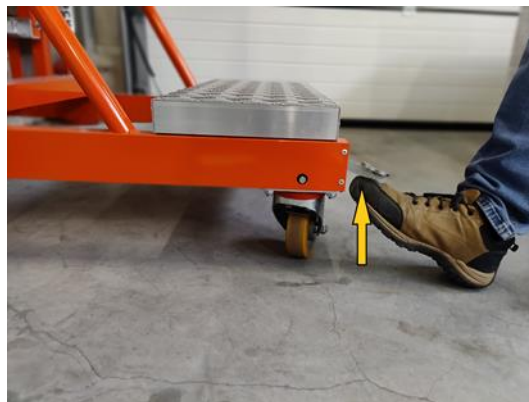
Bild 6. Låsa upp hjulen Genom att lyfta pedalen hjulen låses upp
