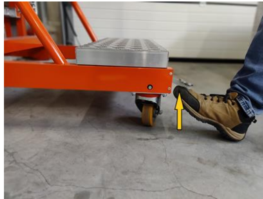
Bild 6. Låsa upp hjulen Genom att lyfta pedalen hjulen låses upp
