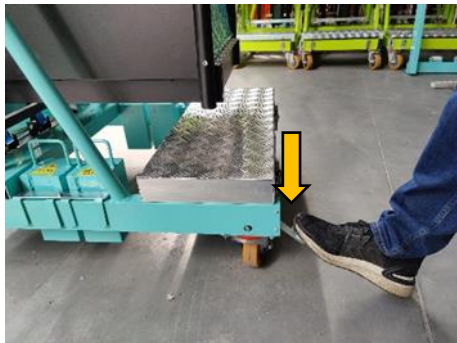
Bild 5. Hjullås Tryck på pedalen orsakar låsning
