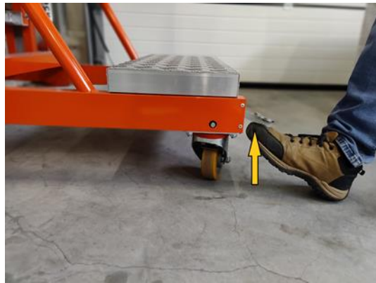
Foto 6. Entsperrleiste der Räder Das Anheben des Pedals entsperrt die Räder
