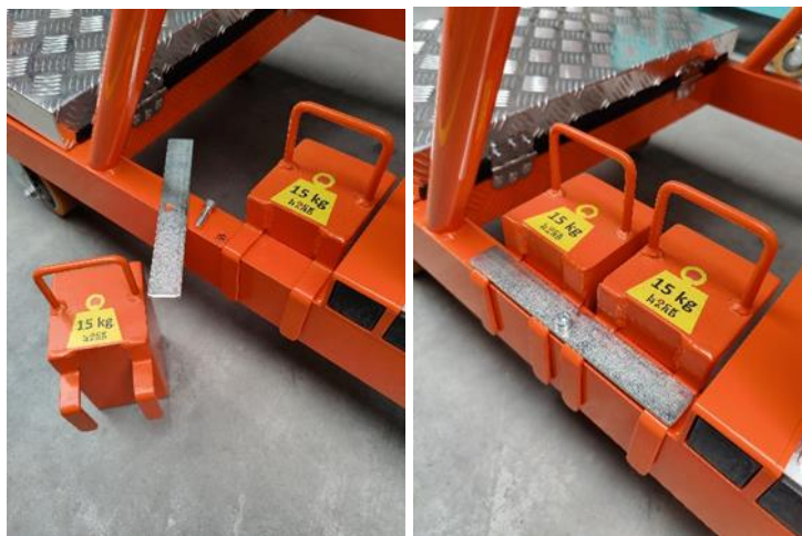
Foto 3. Montage der Ballastgewichte
