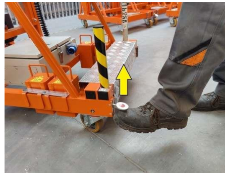
Foto 6. Entsperrung der Räder Das Anheben des Pedals entspermt die Räder
