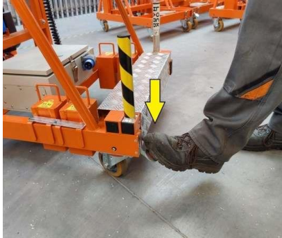
Foto 5. Radsperre Druck auf das Pedal betätigt die Sperre
